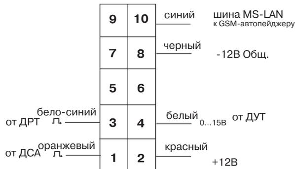
Схема подключения блока MS-BRK
